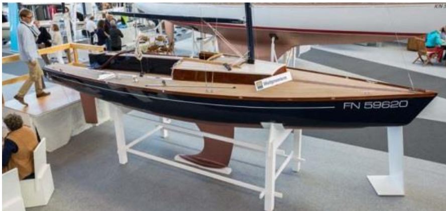
(Abbildung zeigt Prototyp! Serienboot komplett aus Epoxy-Sandwich gefertigt!)
